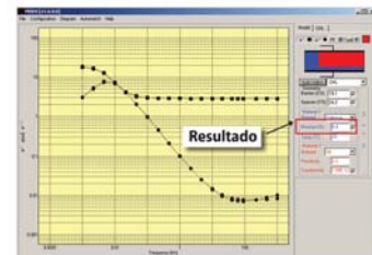
Figura 2: Curva de factor de potencia presentada como capacitancia y pérdidas.
